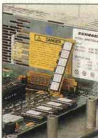
Die SMD-RAM-Chips im Modell 50 und 60 sind auf kleine, in das Motherboard einsteckbare Platinen aufgebracht.
